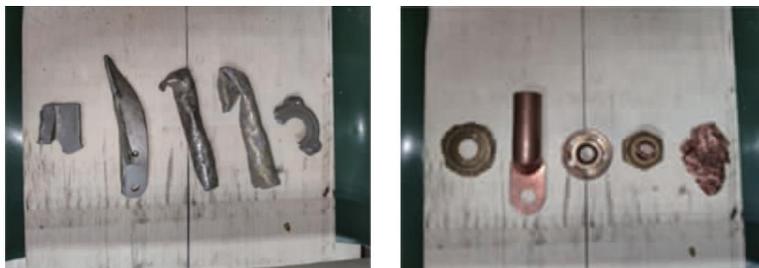
图 4 铝、铜废金属物料样本图
